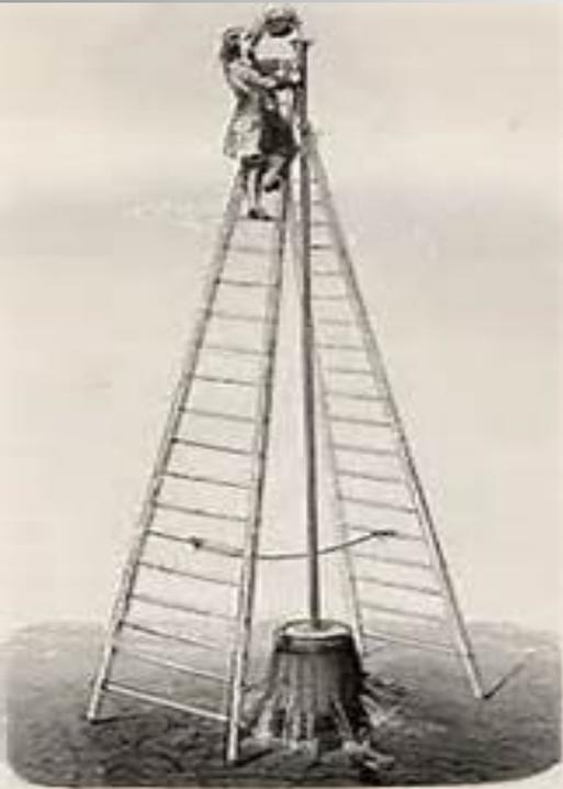
Pascal, spiegava il suo principio con l'esempio della botte piena d'acqua che s'infrange se un tubo sottile e sufficientemente lungo (10,33 m), inserito in essa, venisse riempito d'acqua.
